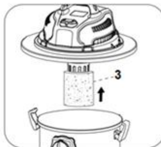
Instalación del filtro
